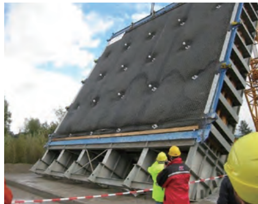
総重量約300t、幅12.5m×長さ10.0m×厚さ1.2m、補強材間隔2.5m千鳥配置
