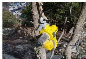
ワイヤーセッター例（既存構造物）
