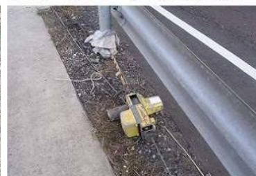
ワイヤーセッター例（既存構造物）
